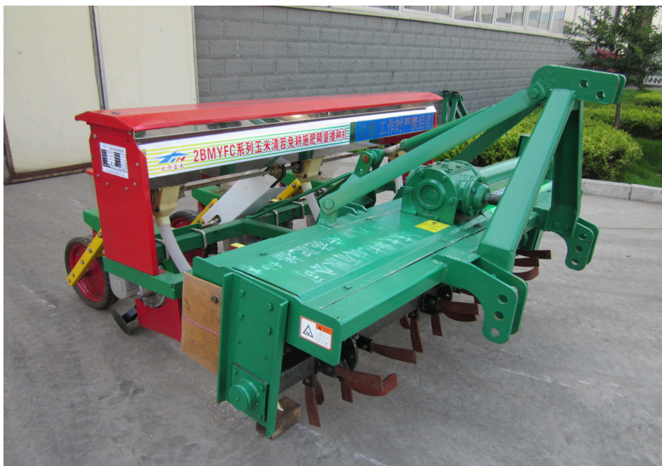
2BMYFC-3/3 型玉米清茬免耕施肥精量播种机
