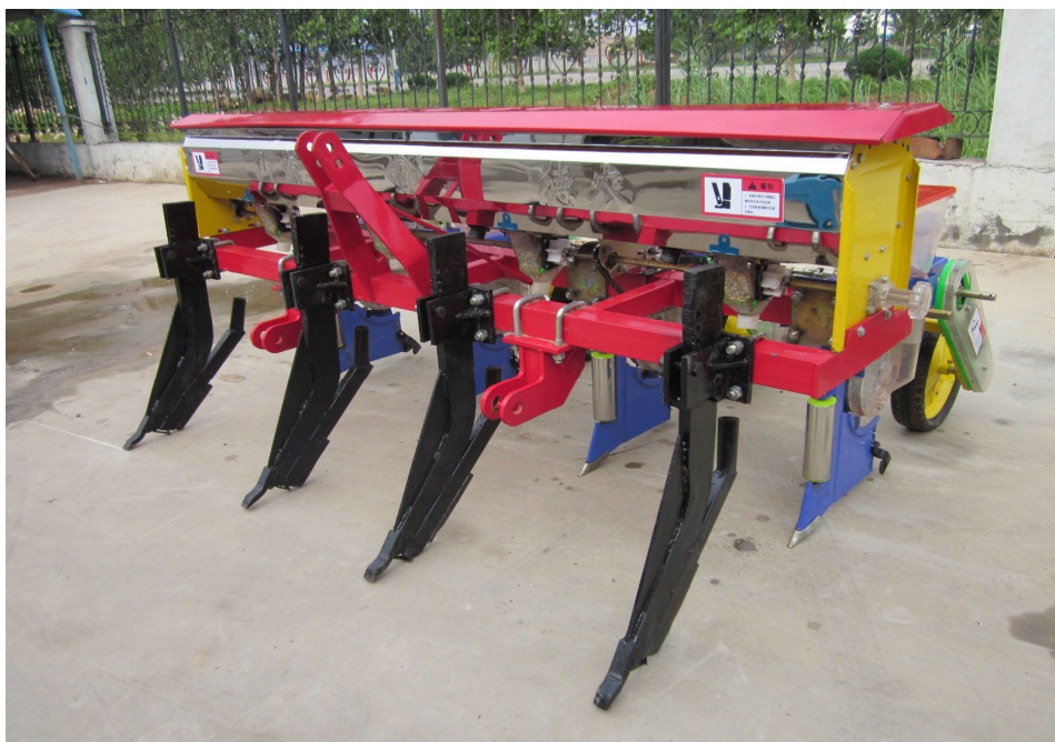
2BMYFS-4/4-4 型玉米深松免耕施肥播种机
