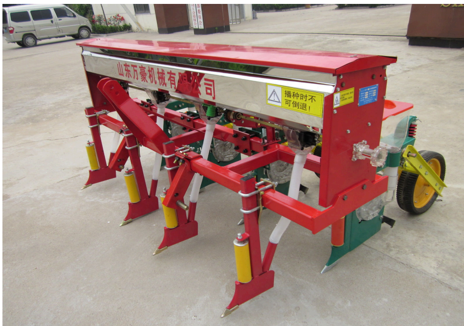
2BYF-4 型玉米精量播种机
