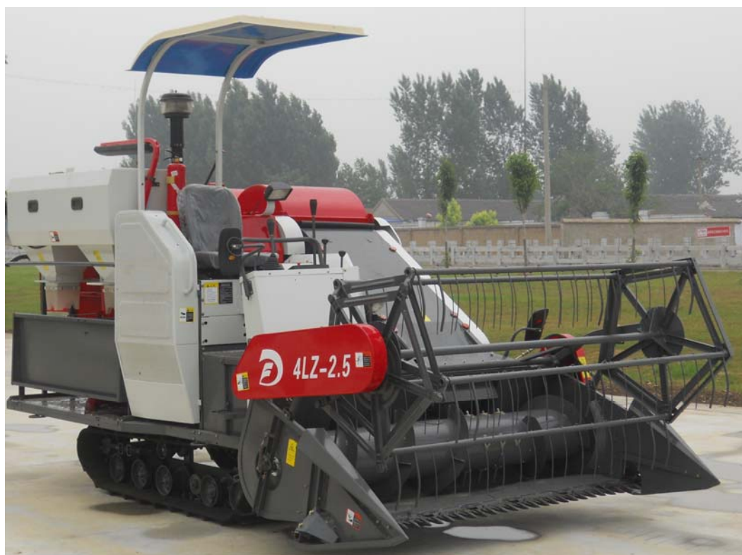
4LZ-2.5型履带式全喂入水稻联合收割机
