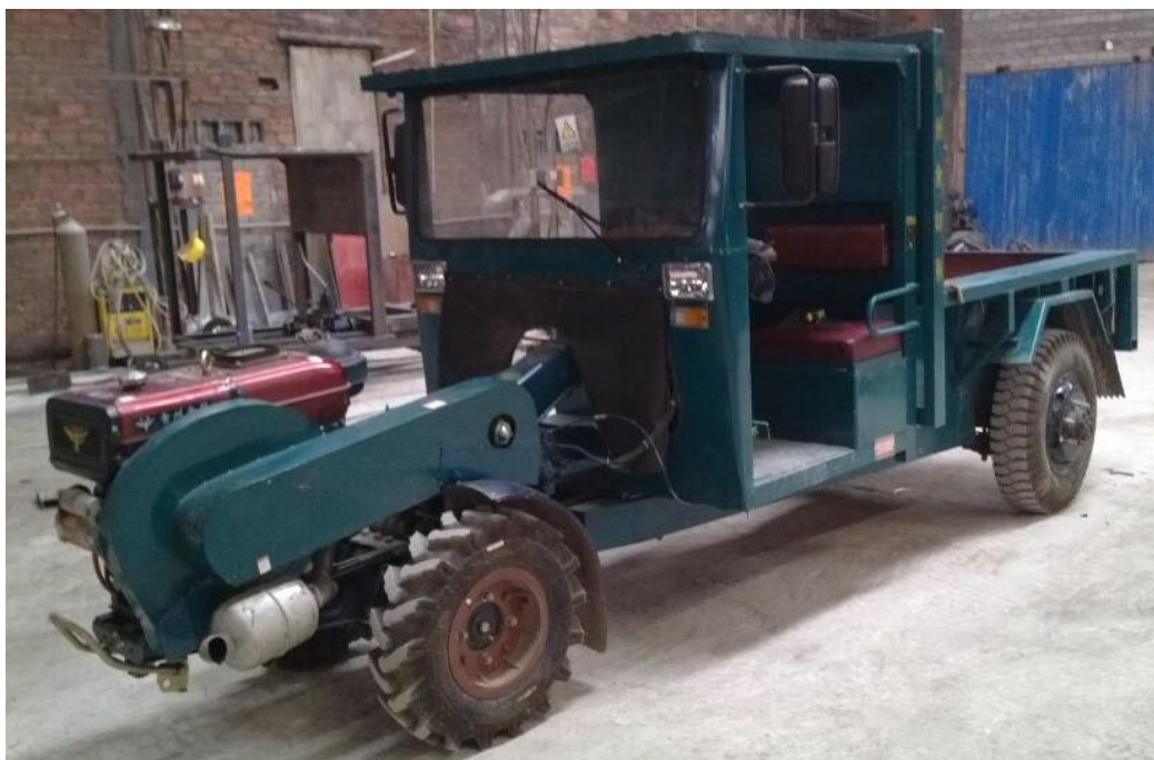
JL15FS 型前后驱动方向盘拖拉机
